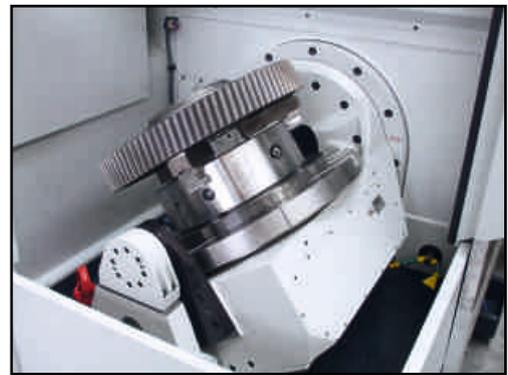
■ Rodamientos en ambos lados del eje e pivoteo
